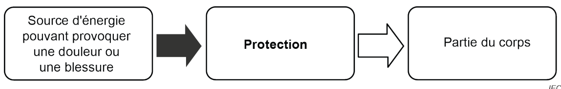
Figure 2 – Modèle en trois blocs pour la sécurité
